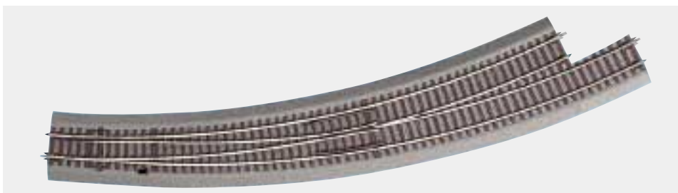
Bogenweiche links BWI 9/10 mit Handantrieb, Radius des Stammgleises und der Abzweigung 826,4 mm (R9)/30°.
