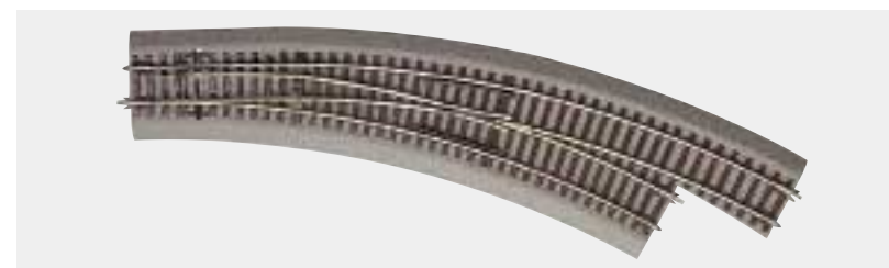
Bogenweiche rechts BWr 5/6 mit Handantrieb. Radius des Stammgleises und des Abzweiggleises 542,8 mm (R5)/30°. Mit Bettung. Passender Elektro-Antrieb: 42620 oder 42624.
